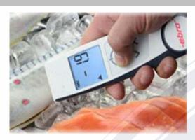
Termómetro Dual con sonda plegable de penetración y sensor infrarrojos.
